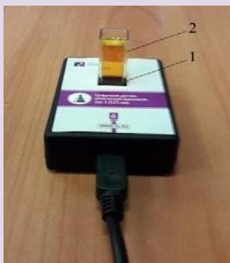
Рис. 1. Датчик оптической плотности: 1 — гнездо для кюветы; 2 — кювета для исследуемого вещества
